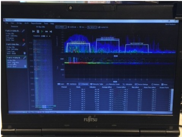
Analyse spectrale Wi-Fi réalisée sur site : l'occupation radio, les recouvrements et les interférences sont visualisés avant toute décision d'ajout ou de déplacement d'une borne. Illustration documentaire ne représentant pas ABC Services.
